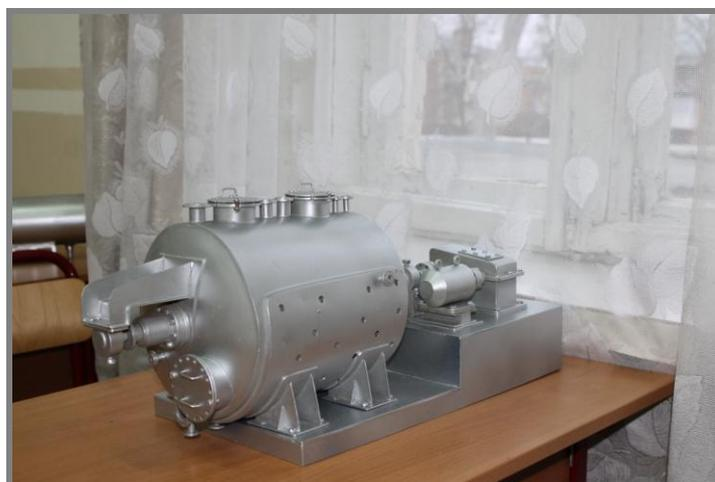
Оборудование для просеивания, подсушки и охлаждения хлопьев
