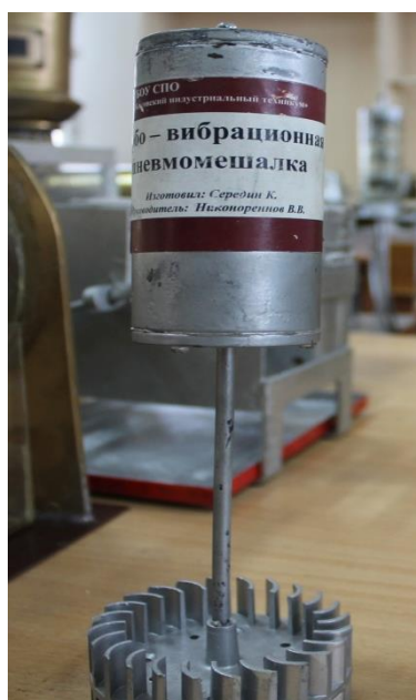
Турбо вибро-мешалка для приготовления халвы из жмыха
